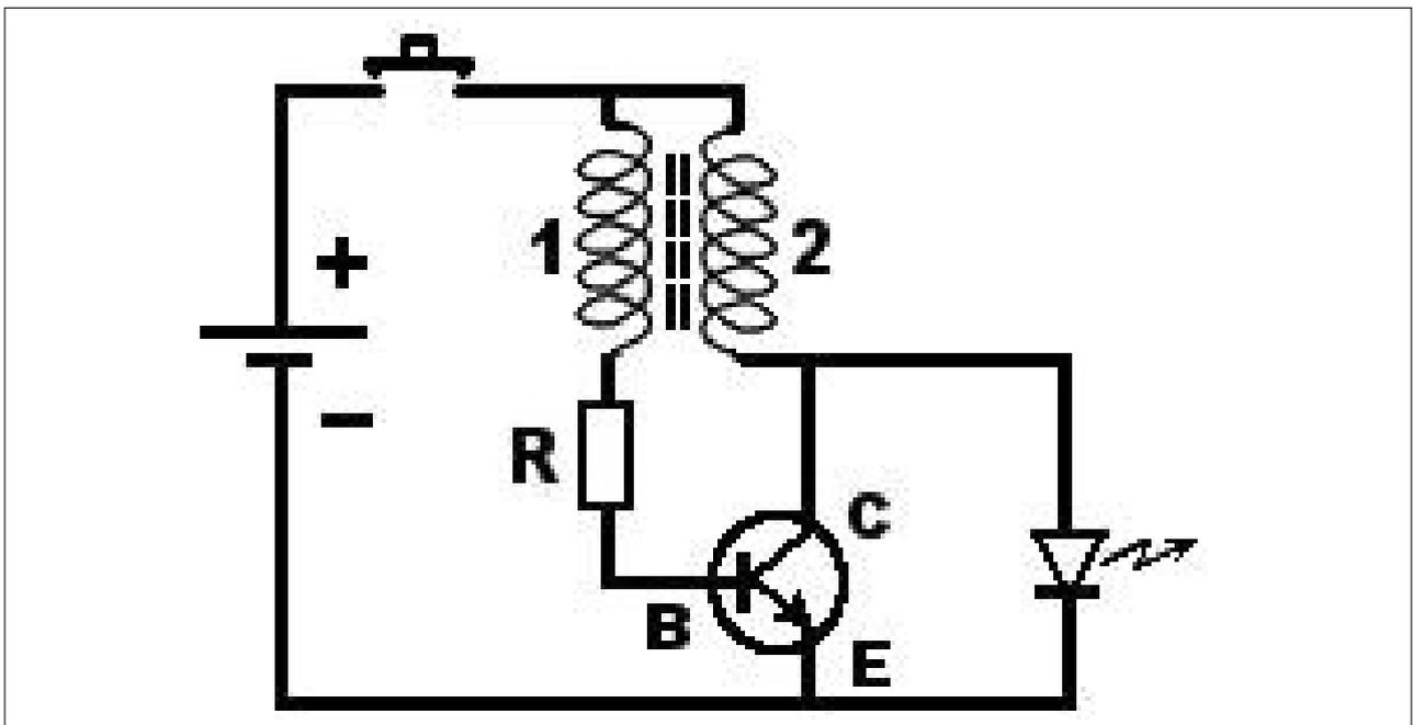
Ce montage est basé sur le principe du voleur de joule décrit en 1999 par Z. Kaparnik.
